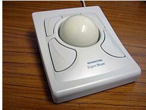
Gambar 11. Mouse dengan mekanisme trackball
