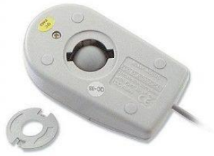
Gambar 10. Mouse dengan mekanisme bola
