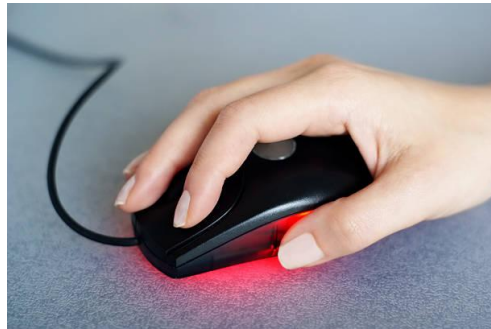
Gambar 11. Mouse dengan mekanisme optik/laser
